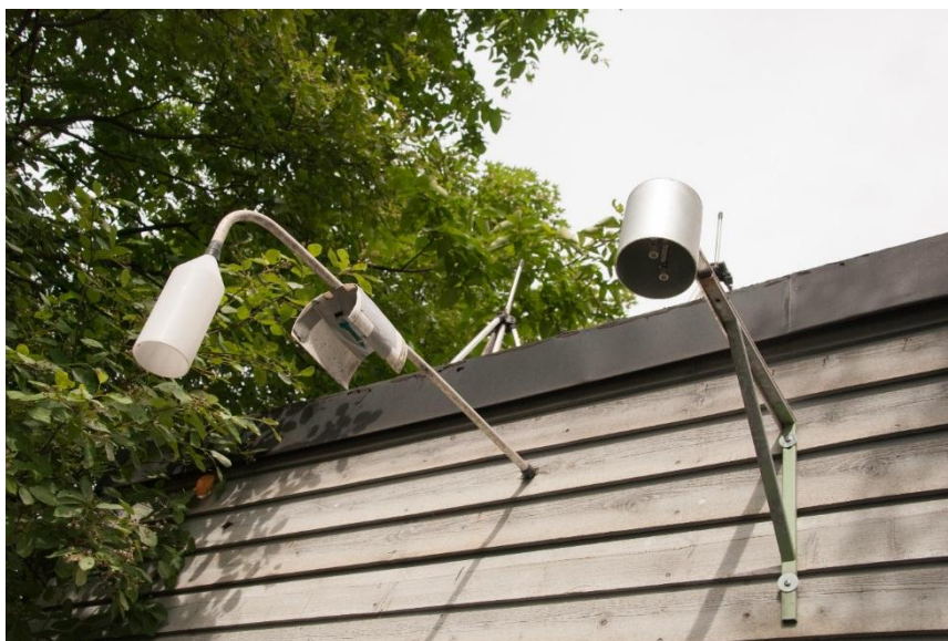
Bilde 1. Plassering av prøvetakere ved Smestad - Molab's prøvetakere er festet under et lite tak laget av plast og tape (venstre) - NILU's prøvetakere er plassert i en aluminiumshette (høyre)
